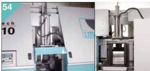
AUTOMATICHE SERIE MAXI - AUTOMATIC MAXI SERIES Dispositivo oleodinamico per taglio a fascio. Hydraulic device for bundle cutting.
