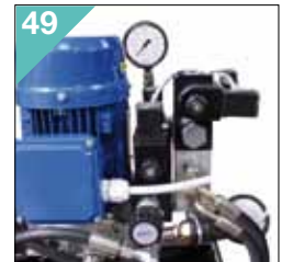
Un riduttore di pressione per morsa idraulica. One pressure reducer for hydraulic vice.
