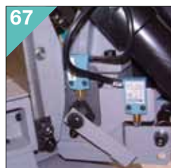
67 000910 RTD RTP Sincronizzatore rulliera / movimento arco. Adapter to synchronize roller table / sawframe motion.
