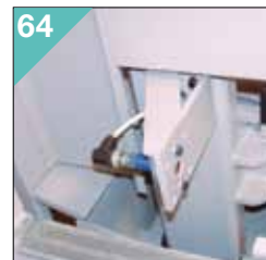
64 Laser di intestatura auto- matica. / Laser detection for automatic trim cut.
